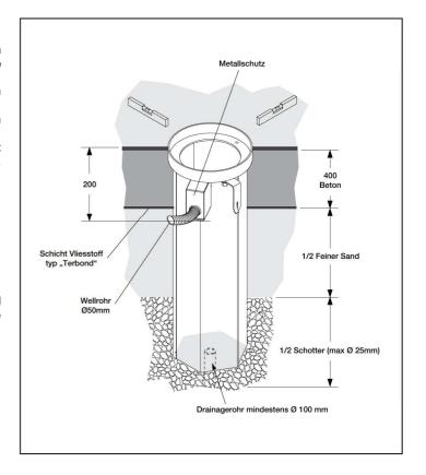
9. Nach dem Positionieren des Kastens den offenen Raum abdecken für die gesamte Zeit, in welcher der Poller nicht eingesetzt ist. Die Abdeckung muss so gestaltet sein, dass Unfälle vermieden werden, die Personen oder Gegenstände betreffen können. Als Option ist ein Stahldeckel mit Aufnahmering verfügbar.
