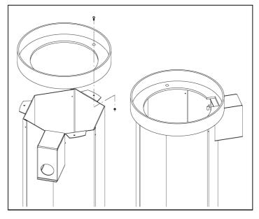
5. Die Betonanker montieren wie in der Abbildung gezeigt, und mit der Unterlegscheibe und der Sechskantschraube M10 in Position blockieren. Je nach Fundament zurechtbiegen.
