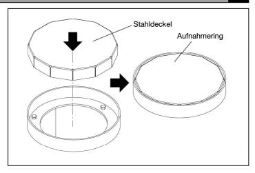
10. Bevor Sie den Poller an seinem Platz einsetzen, entfernen Sie die zuvor angebrachte Abdeckung (Stahldeckel und Aufnahmering). Reinigen Sie dabei sorgfältig den Platz der Verankerung des Pollers, der in der grau dargestellten Zone besteht.
