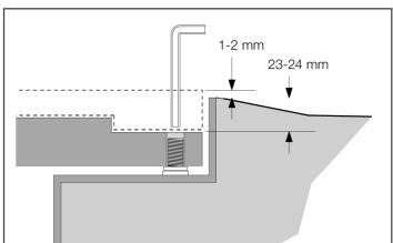
17. Mit dem begehbaren Flansch die Höhe vom externen Fußboden kontrollieren. Eventuell mit den Edelstahlstiften M16 erhöhen und die Planheit regulieren. Die Unterlegscheiben und die Sechskantschrauben M10 einsetzen (siehe seitliche Abbildungen). Die Löcher mit den mitgelieferten Gummikappen verschließen. Nun gemäß mit dem mit der Schaltsteuerung gelieferten Schaltplan den elektrischen Anschluss herstellen.
