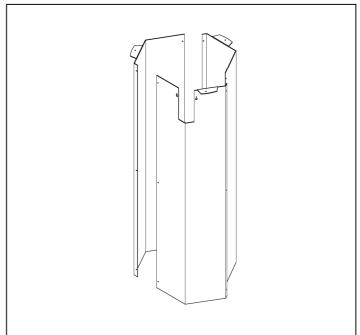
2. Mit Hilfe der mitgelieferten Linsensenkschrauben die hexagonale Struktur zusammenbauen. Die drei Elemente müssen unbedingt vertikal und auf einer vollkommen ebenen Oberfläche zusammengebaut werden, damit eine zuverlässige Auflage für den Verschlussflansch erhalten wird.
