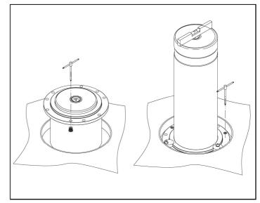
16. Prüfen Sie, dass der Abstand zwischen dem Flansch des Pollers und dem oberen Rand des Kastens/Bodens 23-24 mm beträgt.
