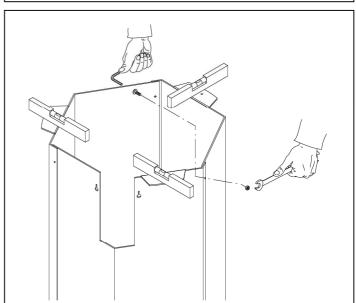
3. Bevor der obere Flansch befestigt wird, die Schutzverkleidung für die Kabelverbindung anbringen.
